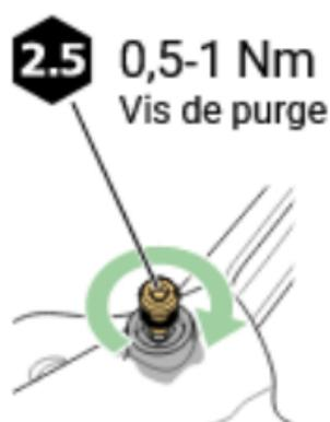
**Serrez avec une vis de purge sur laquelle un joint torique a été fixé.**
